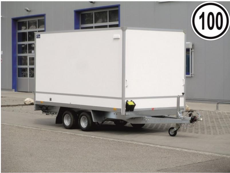
Tür-Lademaß des Koffers mit Heckklappe: B: 171cm x H: 174cm
