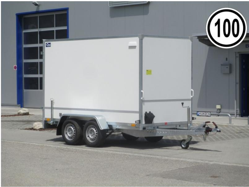
Außenmaße des Koffers mit Heckklappe: L: 460cm x B: 202cm x H: 233cm
