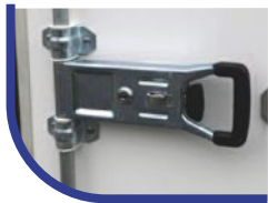
Doppelflügeltür hinten mit Drehstangenverschluss
